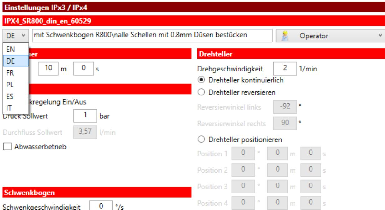
In der Kopfzeile sehen sie die Ausgewählte Testvariante und darunter den Dateinamen dieses Programmes (Rezept) wie er auch am HMI Display der Maschine angezeigt wird.
