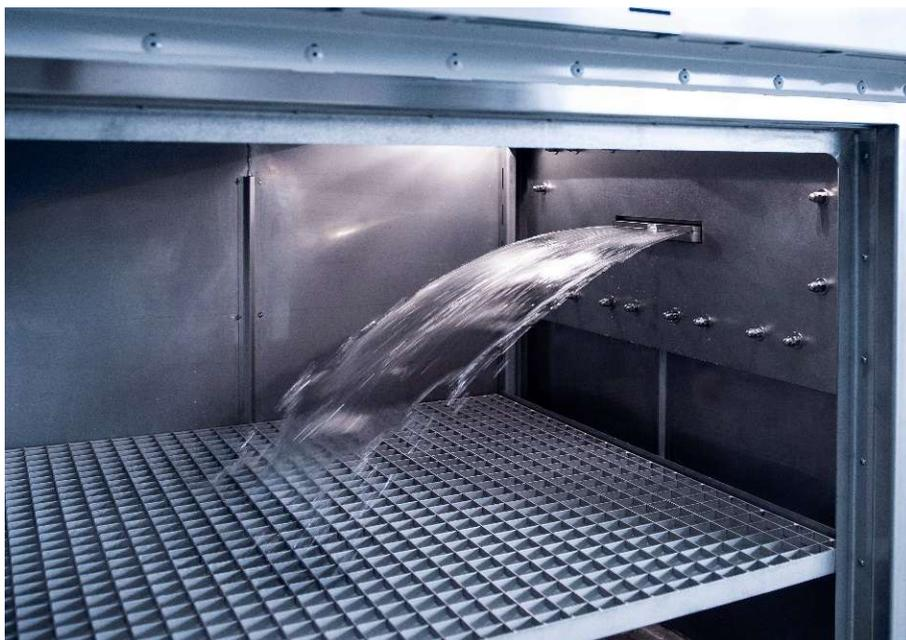
*Einzelne Schwallwasserdüse eingebaut in der rechten Seitenwand*
